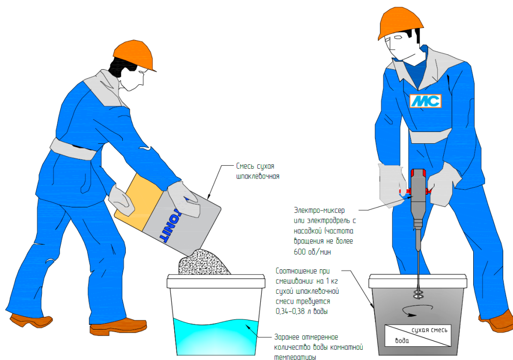
Рис. 21. Организация работ по затворению сухой шпаклевочной смеси
